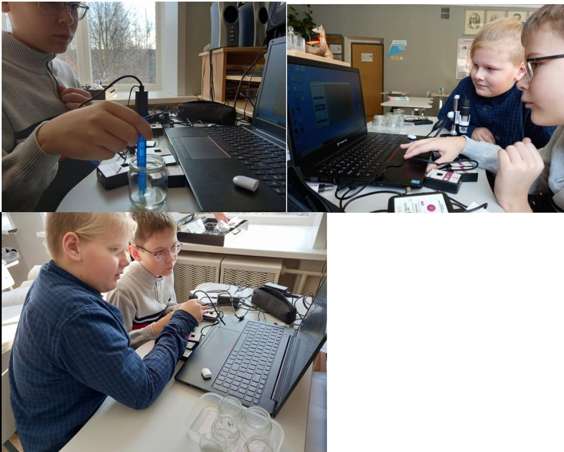
Проводим определение pH и влажности почвы с помощью датчиков pH и программы измерений Releon
