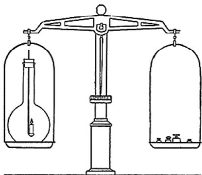
В ложечке закрепляется свеча. Весь прибор в сборе заранее уравновешивается на весах (рис. 8) . Когда учащиеся приходят к выводу, что опыт следует проводить в закрытом приборе, учитель достаёт весы с колбой, зажигает свечу, закреплённую в ложечке, вносит в колбу и плотно закрывает. Учащиеся видят, что равновесие весов не нарушается в ходе всего эксперимента .
